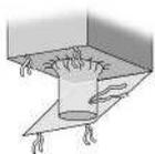
Válvula de Descarga con Tapa
