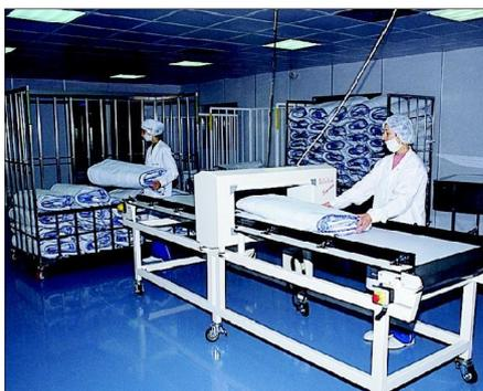
Dentro de la sala limpia, para obtener una línea de producción completamente higiénica, todos los equipamientos están fabricados con acero inoxidable.
